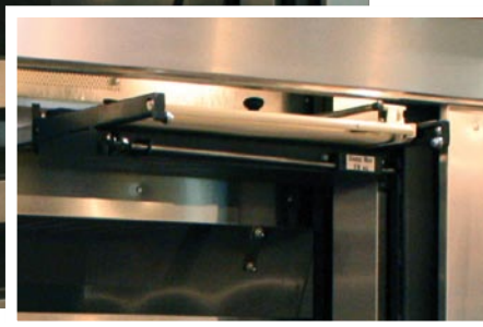
Libérer l'espace devant le four : un avantage clef des dispositifs d'enfournement intégré. (photo Enfouneur escamotable, Map France)
